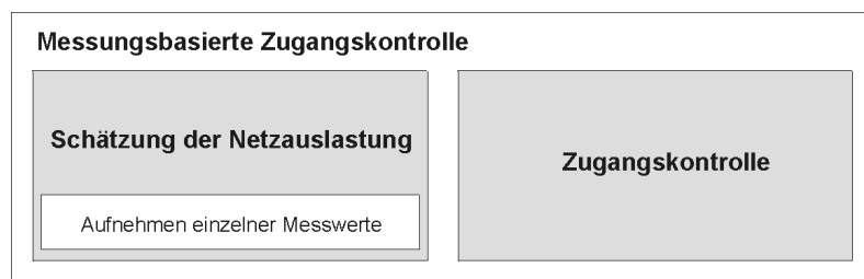
Abbildung 2.8: Komponenten der messungsbasierten Zugangskontrolle
